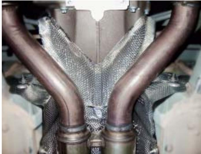
Die Rimic-Technologie ermöglicht beispielsweise an einer Abgasanlage die Absorption von Luftschallenergie bis 8 kHz, bei einer Einsatztemperatur bis 450 °C
