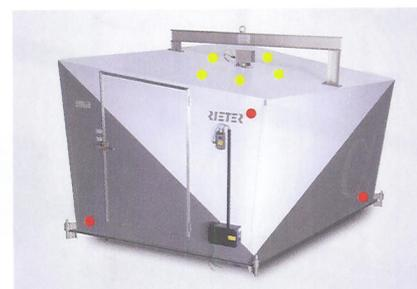
① Ansicht der Alpha-Kabine mit den Positionen der Lautsprecher (rote Punkte) und Mikrofone (gelbe Punkte)
